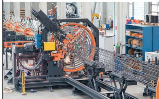
Korbschweißmaschinen für Ramm- und Bohrpfähle, Stützen und Träger
