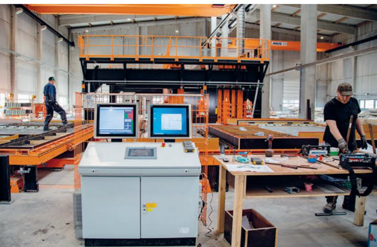
Abb. 6: Das Steuerpult für die beiden Arbeitsstationen mit jeweils einer aufgeklappt daliegenden Schmetterlingsschalung (unmittelbar links und rechts dahinter) sowie der Seitenansicht der Batterie im Hintergrund - die Batterie hat ihr eigenes Bedienpult.
