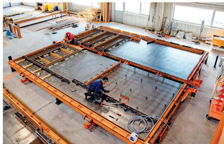
Abb. 7: Blick vom seitlichen Laufsteg der Batterie herab auf die beiden Arbeitsstationen mit den ausgeklappt daliegenden Schmetterlingsschalungen - auf der rechten Schalttafel der komplett sichtbaren Schmetterlingsschalung sind drei Stützen für den Innenraum eines Gebäudes abgeschalt.
