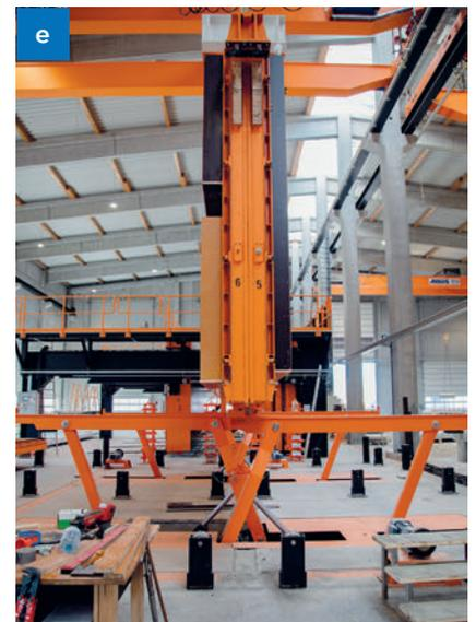
Abb. 9 c-e: Zwei Abus-Hallenkrane mit je 12,5 Tonnen Tragkapazität heben die vorbereitete Schmetterlingsschalung an bis sich die Rückseiten der beiden Schaltafeln berühren (die vorbereiteten Schaltafeln zeigen nach außen).
