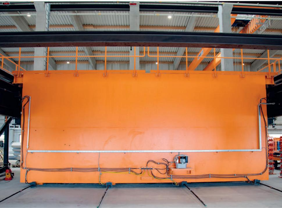
Abb. 4: Frontaler Blick auf die noch unverkleidete, verfahrbare Spannwand der Schmetterlingsbatterie; vier Hydraulikzylinder an der unteren, längeren Kante der Spannwand ...
