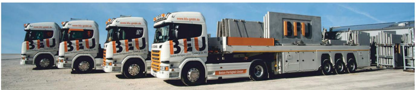
Abb. 12: Fertig zum Abtransport - mit den eigenen Lkw mit Innenladern von Faymonville gelangen die qualitativ hochwertigen, schalungsglatten Betonfertigteile auf die Baustellen in Baden-Württemberg und in der benachbarten Schweiz.
