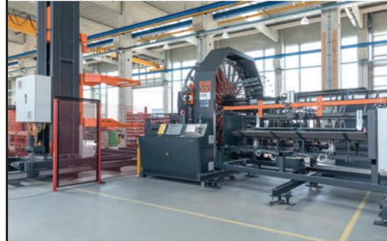
Korbschweißmaschinen für Schacht- und Betonrohrbewehrungen
