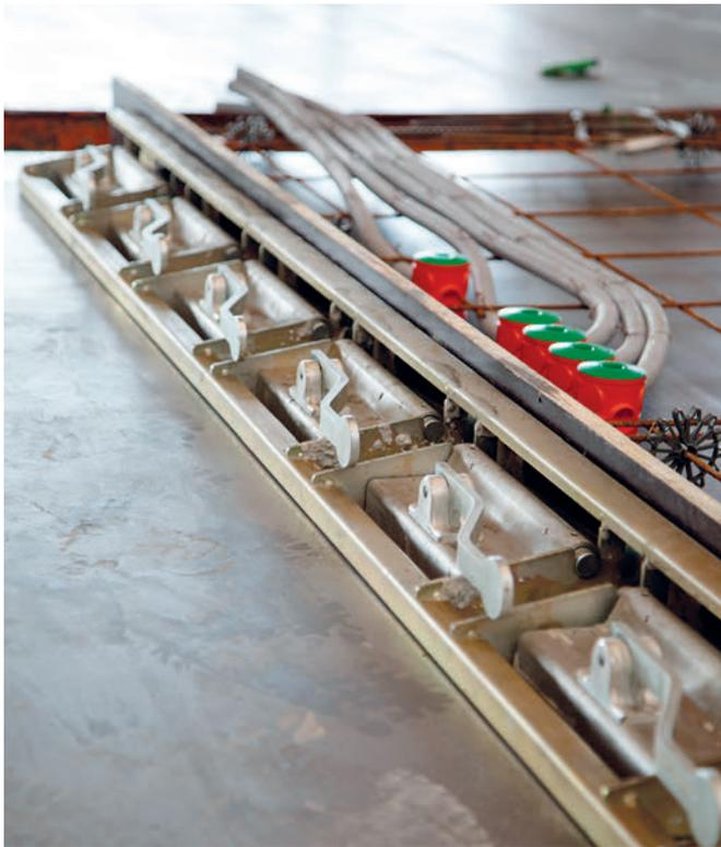
Abb. 8: Für die Anwendung in der Produktion beim Hersteller Beton-Fertigteil-Union wurde das Profil des MultiForm-Schalungsträgers angepasst und verstärkt; außerdem wurde es so gestaltet, dass mehr MagFly-Magnete in kleineren Abständen zueinander platziert werden können. Die Abschaltung hält so auch hohem Druck beim Betonieren in der Senkrechten in der Schmetterlingsbatterie stand.
