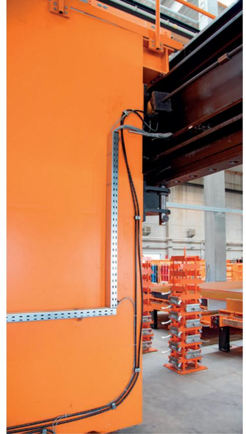
Abb. 5: ... und zwei am Rahmen der Batterie befestigte Hydraulikzylinder garantieren einen dichten Verschluss der Betonierkammern.
