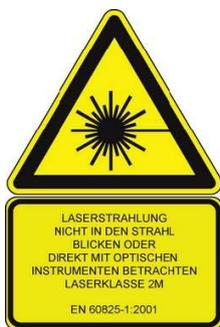
Abbildung 1: Warnschild W10 mit Zusatzschild
