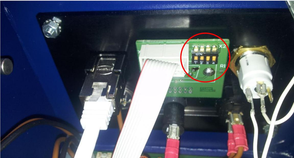
Abbildung 11: Data Interface Board mit Dip-Schalter
