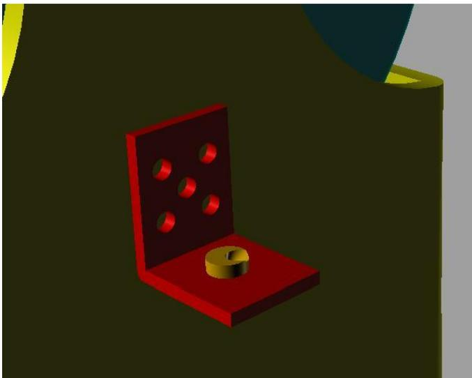
Abbildung 16: Reflektorhalter mit Driftausgleichspunkt
