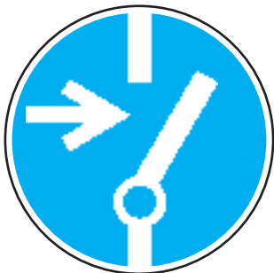
M14 Vor Arbeiten freischalten
